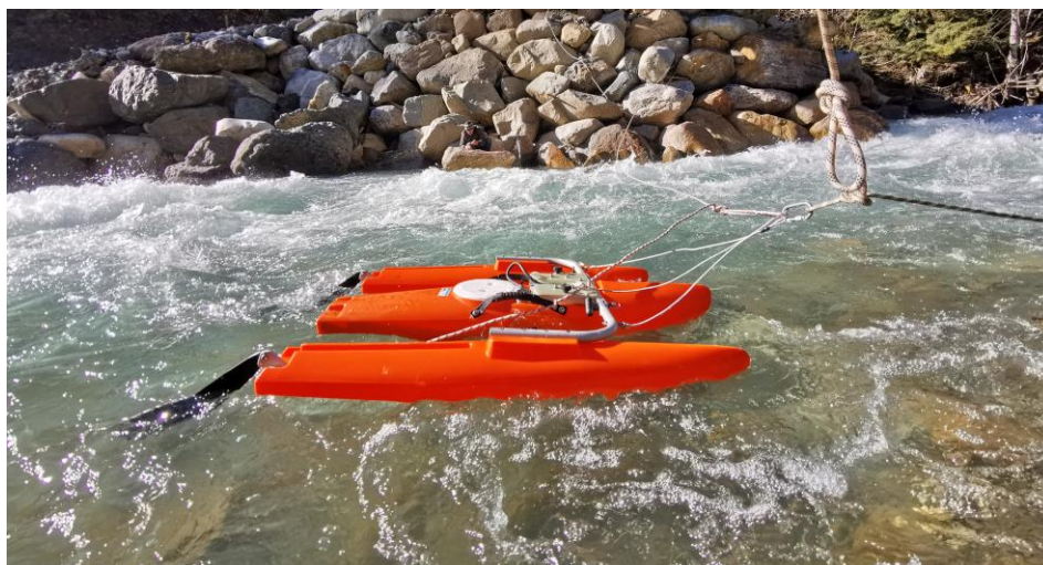
Abbildung 1: RiverPro ADCP bei Feldeinsatz in Georgien
