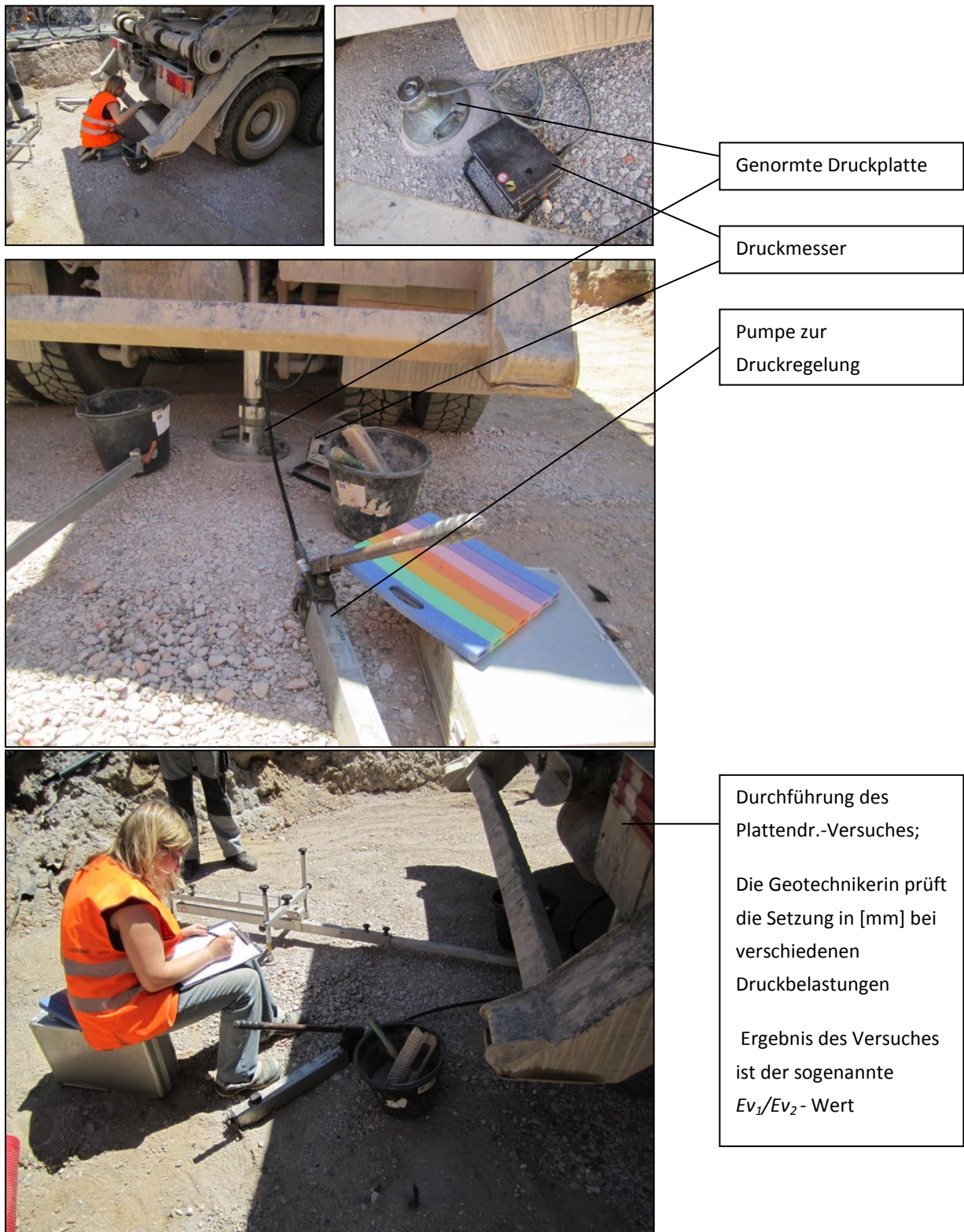
Abbildung 16: der statische Plattendruckversuch
